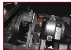
4 ボルトメイン、鍛造スチールクランク、パウダーメタルコンロッド、ウィンデージトレイ
